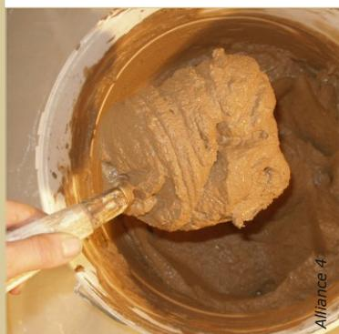
La consistance des mortiers de finition est onctueuse et ferme, type fromage blanc battu.
