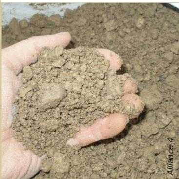
Le gravier sableux de ponce 0-14 mm est une mélange complet de sable fin, sable moyen, gravier fin et gravier grossier.
