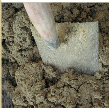
Chaux aérienne, sable et plâtre pour un mortier à prise rapide, très dur et résistant en extérieur.
