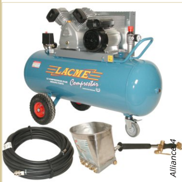
Le sablon est un récipient dans lequel sont introduits plusieurs litres de mortier. Il est raccordé à un compresseur. Sous l'effet de l'air comprimé, le mortier est projeté par les buses.
