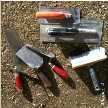
Les outils indispensables du maçon sont : truelles, taloches, platoirs, langue de chat et brosse à mouiller.
