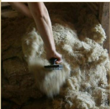
La taloche à pointes sert à carder la filasse pour l'aérer. C'est un mouvement de grattage rapide et souple.
